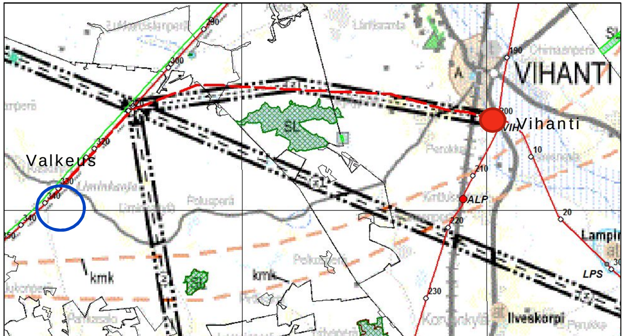
Kuva 2. Ote Hanhikiven ydinvoimamaakuntakaavasta, jossa mustalla katkoviivalla on varauduttu kantaverkon tuleviin perusratkaisuihin. Valkeuden sähköasemaselvitysalueen likimääräinen sijainti on esitetty sinisellä ympyrällä ja suunniteltu 110 kV voimajohto punaisella katkoviivalla.
