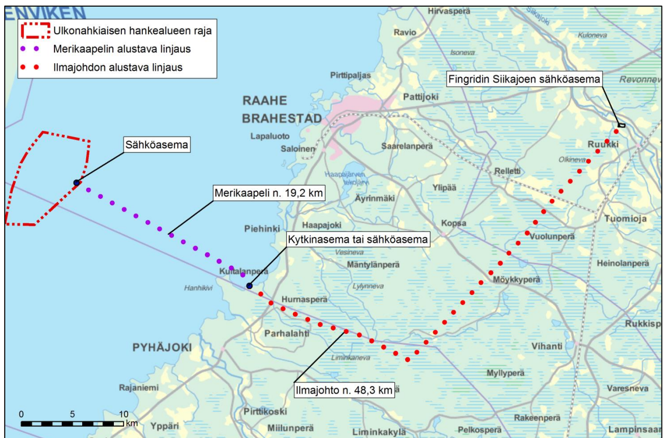
Kuva 2.5. Sähkönsiirtoyhteys tuulivoimalaitoksesta kantaverkkoon.
