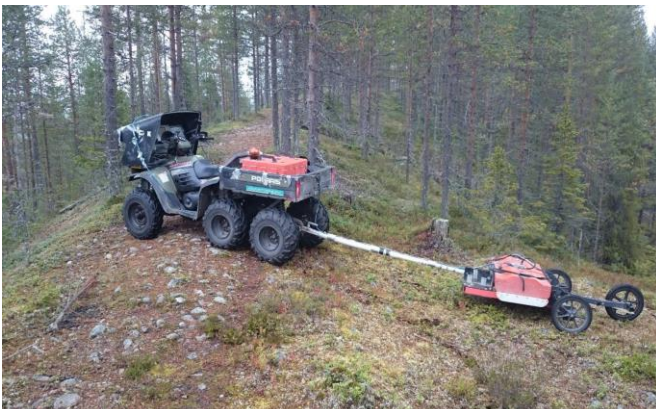
Kuva 7. Hankkeessa käytetty maatutkaluotauslaitteisto. Kuva: GTK.
