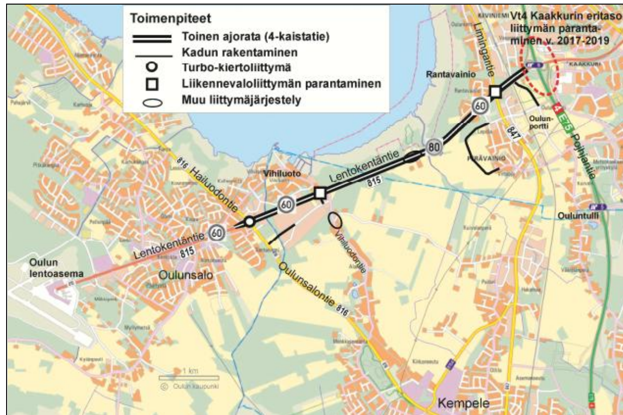
Kuva 14. Vaihtoehto VE 1; nelikaistainen Lentokentäntie ja tasoliittymät.
