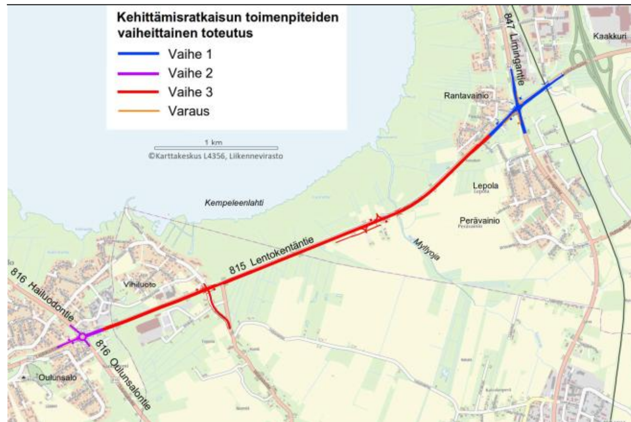
Kuva 30. Esitys Lentokentätien vaiheittain rakentamisesta.
