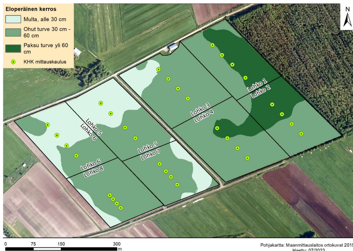
Kuva 5. Turpeen syvyyden vaihtelu Ruukin NorPeat-tutkimusturvepellolla (Kuva: Miika Läpikivi, Oulun yliopisto). Vihreät ympyrät osoittavat missä kasvihuonekaasupäästöjen mittauskaulukset sijaitsevat.
