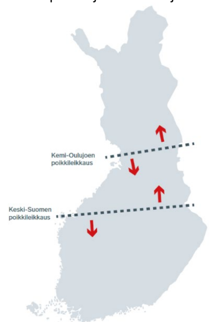
Kuva 34. Suomen sisäiset pääsiirtoleikkaukset. Tulevaisuudessa leikkausten sijainnit voivat muuttua muun muassa sähkön tuotannon ja kulutuksen sijoittumisen seurauksena (Sähköjärjestelmävisio 2023).
